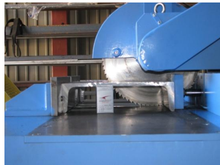
C形鋼 380 x 100 x 20 x 13 切断例
